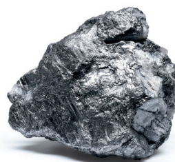
Erz aus Sri Lanka: eine besondere Struktur und ein hoher Graphitgehalt von bis zu 99 % zeichnet das Erz aus
